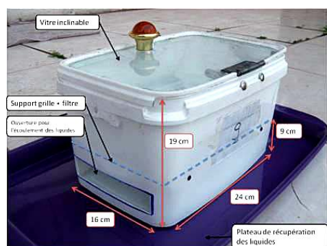
Mini-four solaire (vue extérieure).
