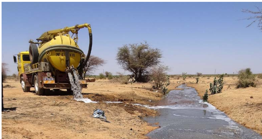
Déversement de boues fécales dans un cours d'eau : une charge de matière organique trop élevée pour être épurée par les bactéries.
